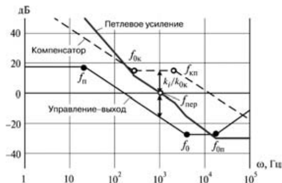
Рис. 10. Передаточные функции, необходимые при разработке компенсатора
