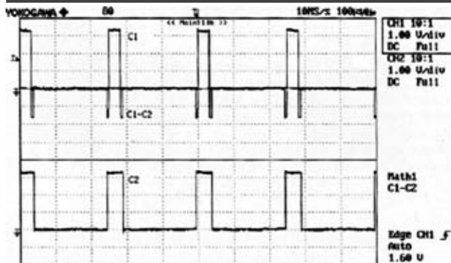
Рис. 7. Сигналы управления обоими инверторами и их разность
