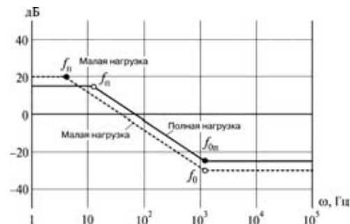
Рис. 9. Передаточная функция управление-выход при изменении сопротивления нагрузки для РРТ
